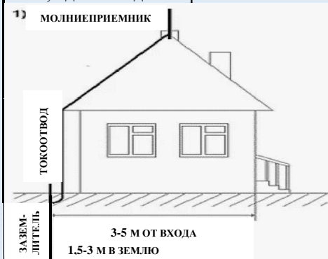
Металлический штырь. Как правило, это стальной металлический стержень длиной от 0,5 до 4 м и диаметром 10-12 мм.
